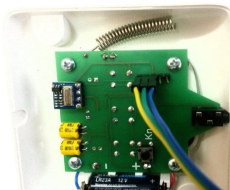
Рисунок 3. Подсоединение кабеля к радиоадаптеру
