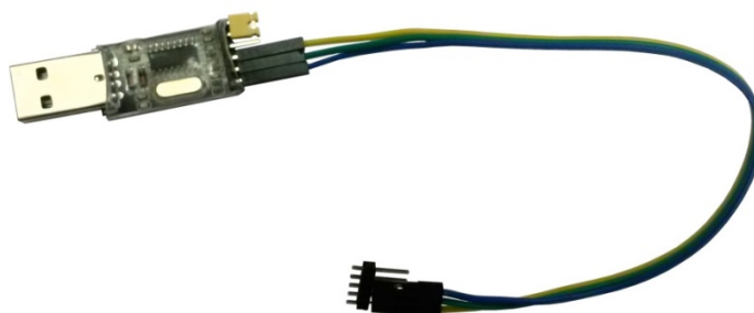
Рисунок 2. Переходник USB-UART с кабелем
