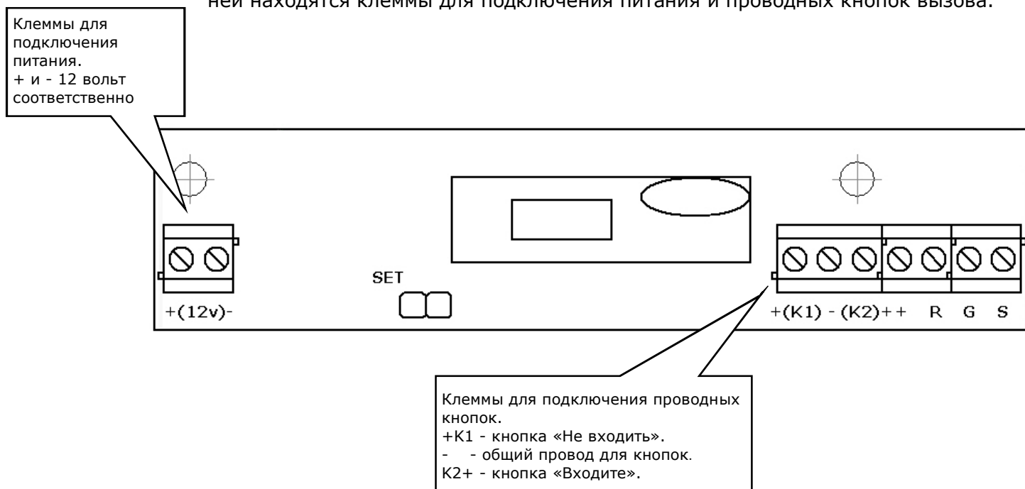
Рисунок 6.1. Печатная плата на задней стороне корпуса светозвукового табло
