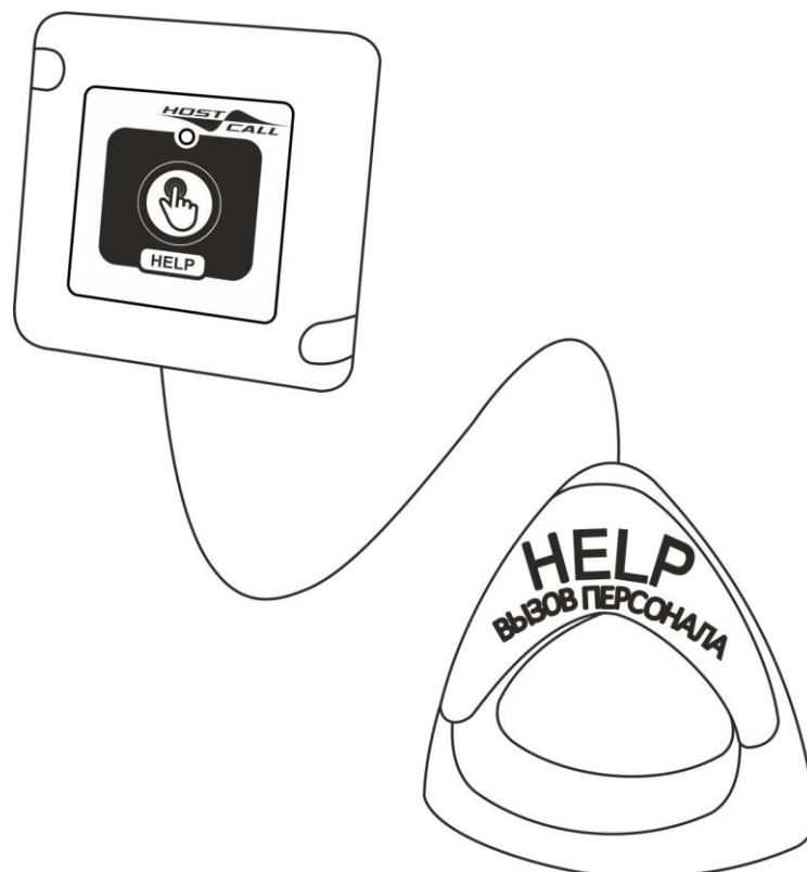
Рисунок 5.7. Влагозащищенная радиокнопка вызова со шнуром МР-413W1
