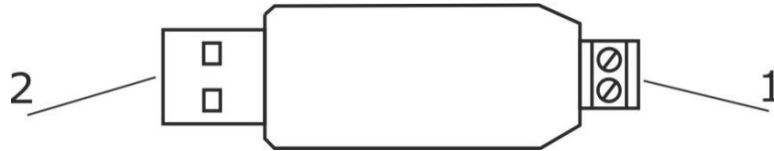
Рисунок 1. Внешний вид преобразователя интерфейсов MP-251W3
